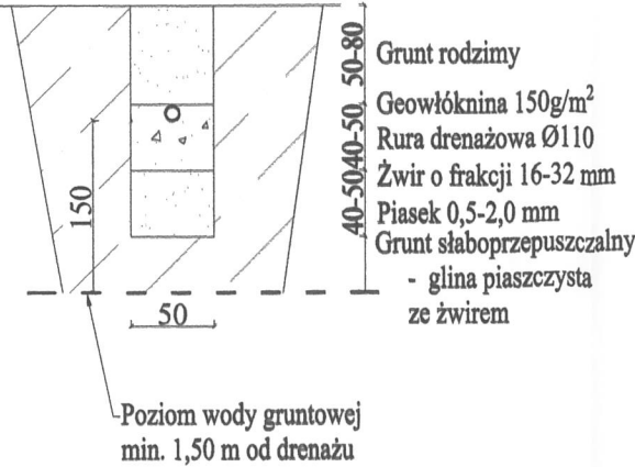
Przekrój wykopu pod drenaż
